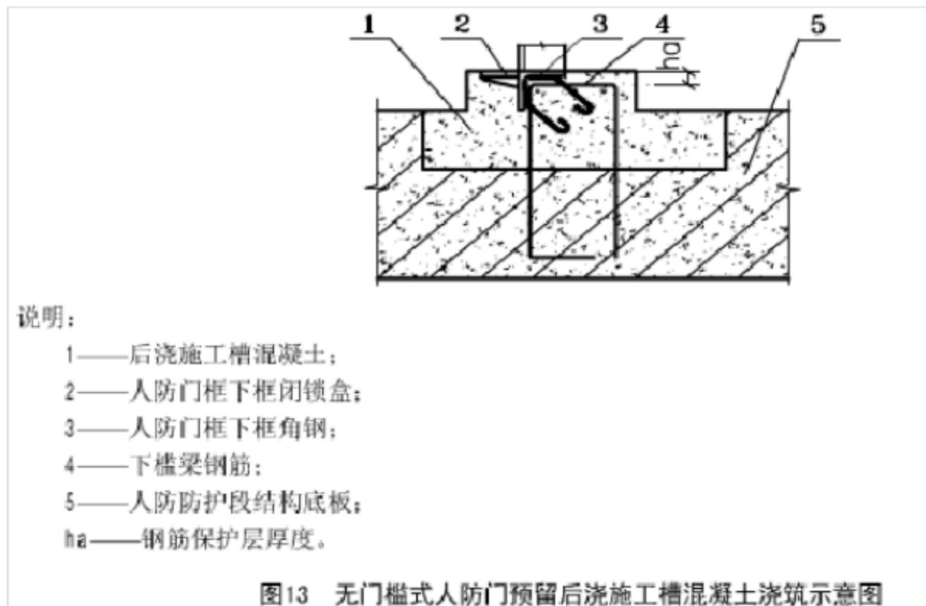
d) 地铁区间人防门框预留后浇施工槽混凝土浇筑除应符合上述规定外，还应符合人防专业设计单位给出的其他要求。
