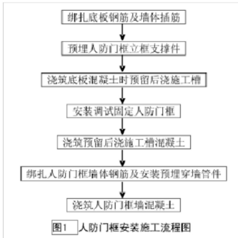
6.1.1.2 地铁区间人防门框安装流程应由人防专业设计根据其构造给出， 施工单位和人防门安装队应依据设计给出的流程进行施工。
